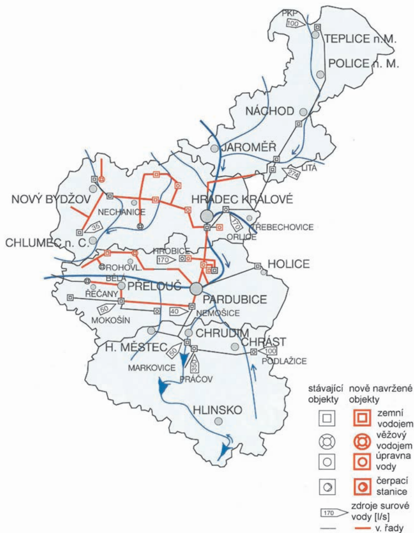
Obr. 2.2 Schéma Vodárenské soustavy východní Čechy, zdroj: Vodárenské soustavy v ČR
